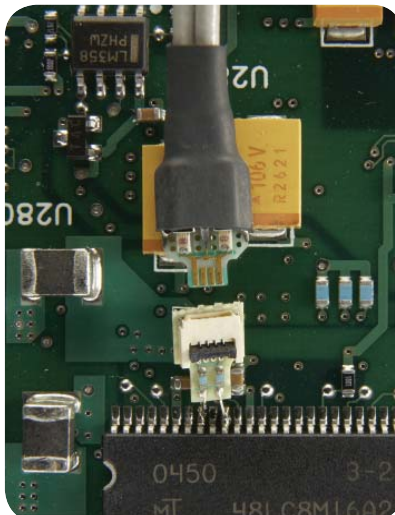
InfiniiMax ZIF tip soldered on board
