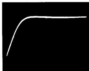
Actual 228A transient response, 100V range @ 1A. Vert.: 20V/div. Horiz.: 0.2msec./div.
